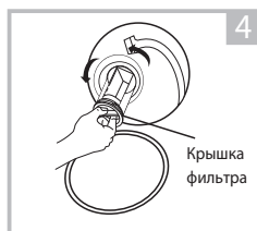
Откройте крышку фильтра, повернув против часовой стрелки
