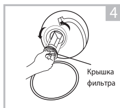
Откройте крышку фильтра, повернув против часовой стрелки
