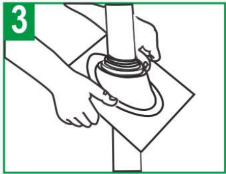
Снимите элементы кровли вокруг трубы, натяните уплотнитель на трубу
