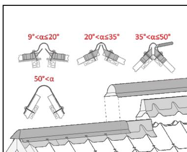
Монтаж узлов кровли смотри в инструкции по монтажу. Гвозди — в каждую волну. Последний штрих — заполнитель для закрытия просветов.
