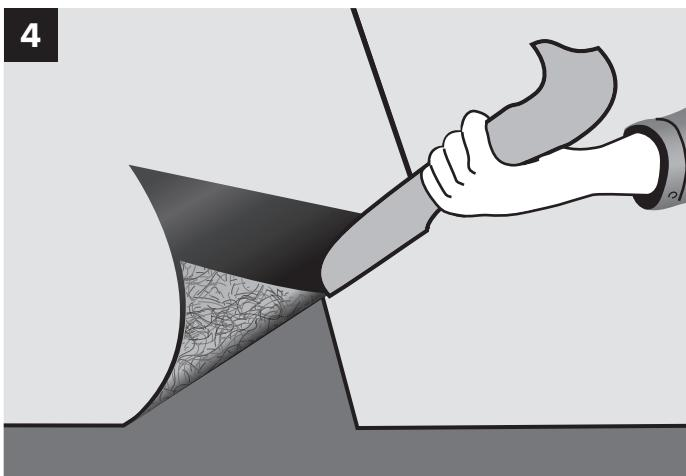
Раскатать следующий рулон и сформировать боковой нахлест. Важно! Следить за тем, чтобы звукоизоляционный слой вплотную прилегал к кромке соседнего полотна. Если этого не сделать, в конструкции образуются звуковые мостики, через которые распространяется шум. Затем удалить защитную пленку и склеить полотна между собой.
