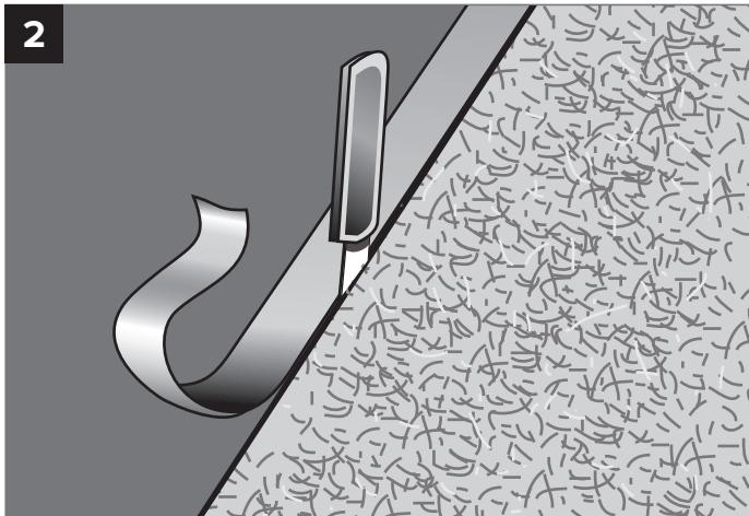
Материал необходимо уложить таким образом, чтобы образовать единый звукоизоляционный слой, заходящий на вертикальные поверхности помещения на высоту финишного напольного покрытия. Начинать укладку от угла комнаты вплотную к стенам и перегородкам звукоизоляционным слоем вниз.
