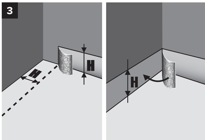
Формирование внутреннего угла. Надрезать участок материала равный высоте финишного покрытия пола (H). Завести торцевую часть материала на вертикальную поверхность на данную высоту и загнуть боковой отрезок.
