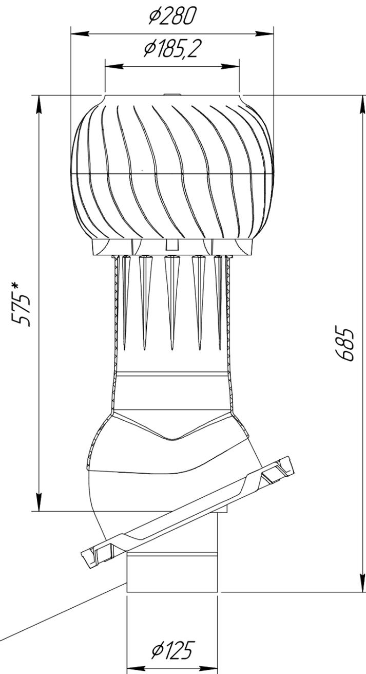
Возможны варианты с внутренним воздуховодом  $\phi 110$  мм и  $\phi 150$  мм
