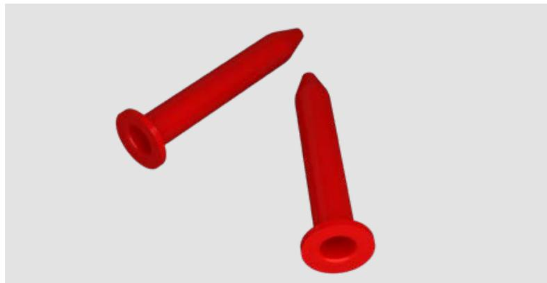
Телескопический крепеж TERMOCLIP 6 обеспечивает надежную фиксацию гидроизоляционных материалов к несущим основаниям кровли из профлиста, бетона и дерева, а также к парапету. Применяется совместно с остроконечными и сверлоконечными саморезами диаметром 4,8 мм и прижимной стальной рейкой в шве TERMOCLIP.
